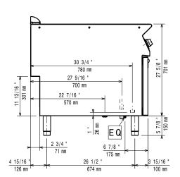
ΕI Electrical inlet (power) EQ Equipotential screw Water inlet
